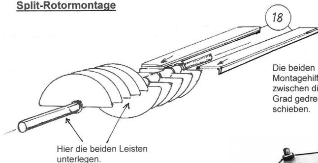
Die beiden Montagehilfsstreifen zwischen die beiden um 180 Grad gedrehten Pakete schieben.
